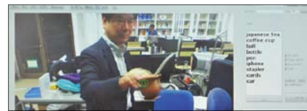
SOINN 搭載の HIRO の視界と、蓄積した情報の管理画面。左の映像のように、近くにあるものを自ら目線で追いかけて認識する。右のウィンドウには覚えた“モノ”の名称が表示されている。
